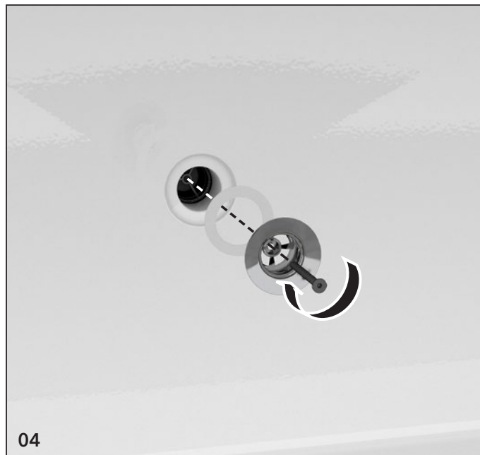
04 Siphon und Auslauf mit den entsprechenden Dichtungen festschrauben, dabei bei der Innenseite der Wanne beginnen. Serrer le siphon avec la vis et la bonde avec les joints fournis depuis l'intérieur de la baignoire.
